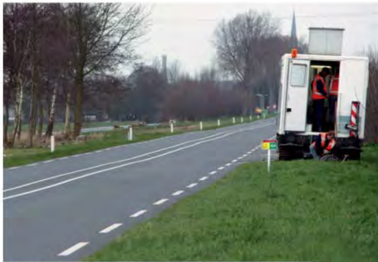
Figuur 4 – Aanprikken van het 75 jaar oude rijen bed ter plaatse van het proefvak Stolwijk In 2009. Deze weg is ten opzichte van de oude weg iets naar links opgeschoven en ligt nu gedeeltelijk op de vroegere trambaan. FOTO DELTARES
