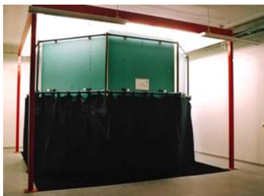
Figur 26 Fra venstre; Kunstig Himmel sett fra utsiden. Fra høyre; vertikalt snitt med høyde på 3 meter. Foto: Barbara Matusiak
