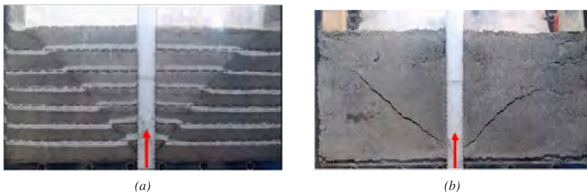
Fig. 7: Opptreksforsøk i mini-testtrigg med (a) friksjonsmaterial og (b) material med låg kohesjon.
