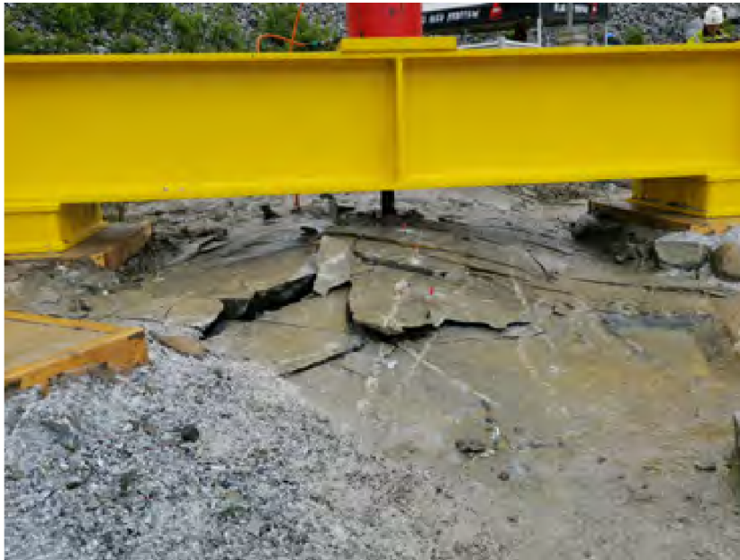
Fig. 11: Brot i bergmassen rundt staget.
