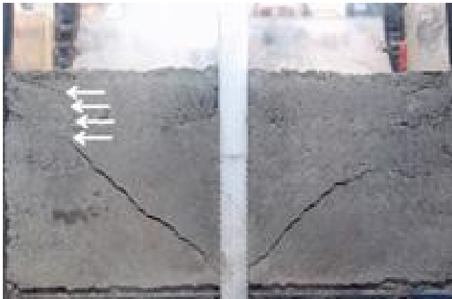
Fig. 14 Bruddmønster for test C.1 Bruddsone som går oppover overflaten, med en rekke sub-horisontale brudd under blokken.
