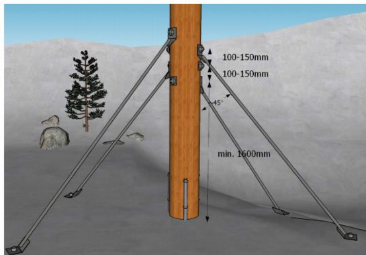
Figur 22 - RT0413 - Montering av stolpestag
