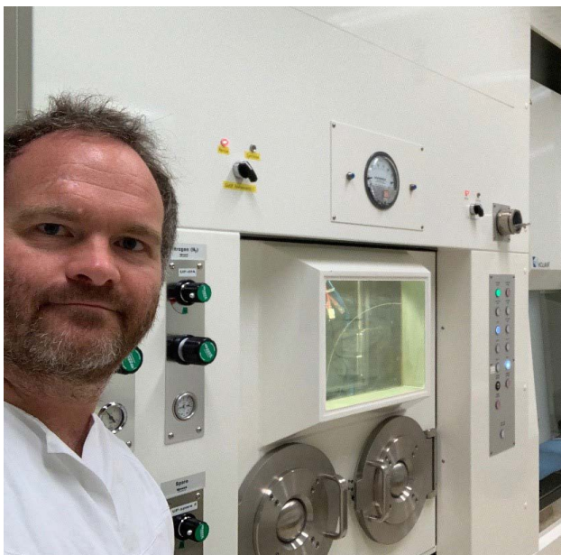
Bilde 2: Hotcelle for prosessering av ^{45}\text{Ti}
