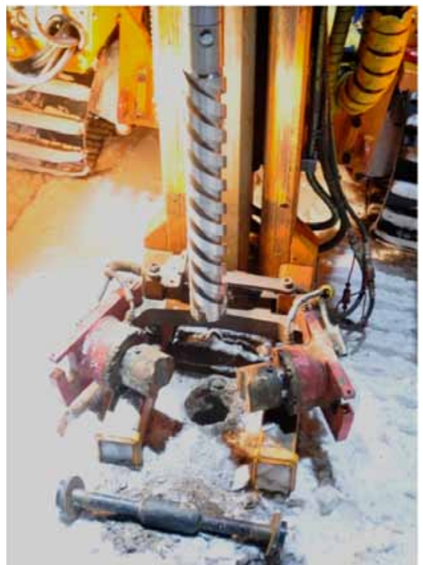
Fig. 40. The SINTEF Permafrost Corer.
