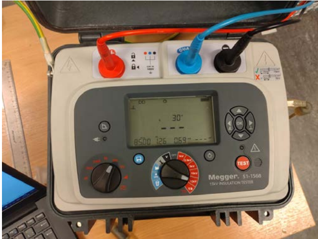
Figur 2: Megger S1-1568, som er benyttet til å utføre målinger i denne studien.
