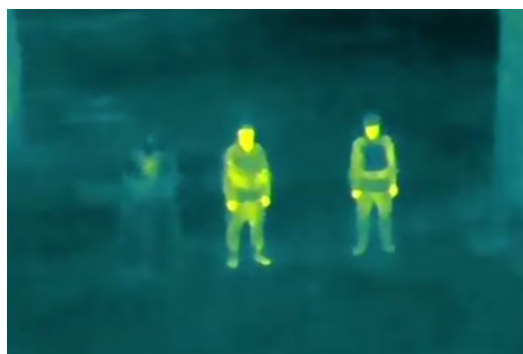
Figur 9 Bildet illustrerer hvor synlig en soldat kan være på termiske kameraer. Soldaten helt til venstre (av totalt tre soldater) har på seg en spesiallaget drakt som kamuflerer hans termiske signatur. (Pravda, 2023)
