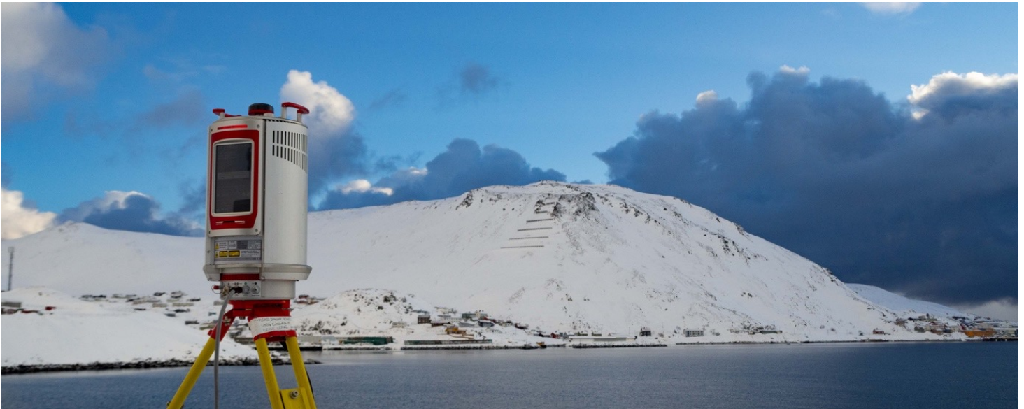
TLS (terrestrial laser skanner) for å skanne snødekket i fjellsidene over Holmbukt i Honningsvåg, februar 2022. Foto: Holt Hancock
