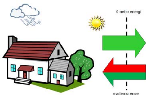
Fig 2.7 Prinsippløsning for betraktning av et 0-energi bygg. Figur indikerer balanse for mengde levert energi. Imidlertid er andelen som leveres fra bygget vektet med en lavere miljøbelastning (grønn) enn den energien som leveres inn (rød/grønn). Bygget er følgelig også et – (negativt) utslippsbygg.
