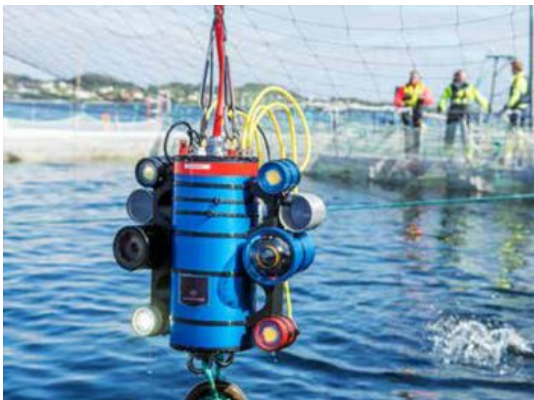
Avansert kamerarigg: 4000 mikrolinser og LED-lys bidrar til sylskarpe undervannsbilder. Bildebrikken gir 8K oppløsning. Med tiden er planen å gjøre riggen autonom.
